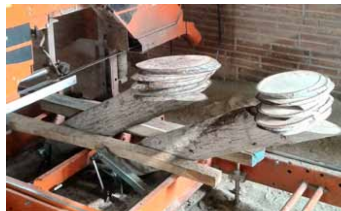
Corte transversal oblicuo de troncos de nogal
