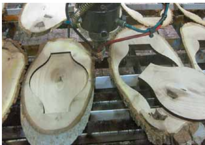
Pruebas de cortes con láser en madera de nogal seca en AIMEN
