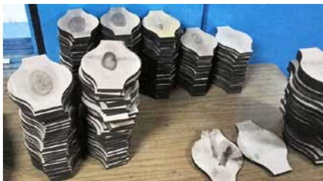
Corte láser de piezas oblicuas una vez secas
